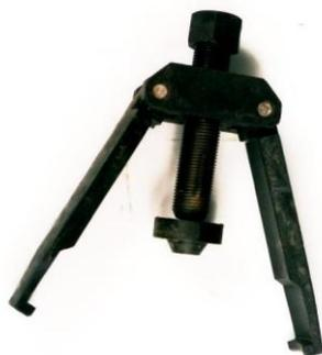
**Alicate para extrair e colocar os pinos das sapatas de freio dos veículos: ônibus e caminhões Volvo FH, NH e B12**
