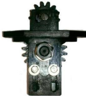
Ferramenta para girar, através do volante, a árvore de manivelas do motor IVECO
